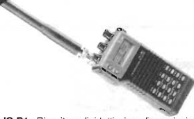
IC-R1 - Ricevitore di ridottissime dimensioni per ricezione da 100kHz a 1300 MHz.
